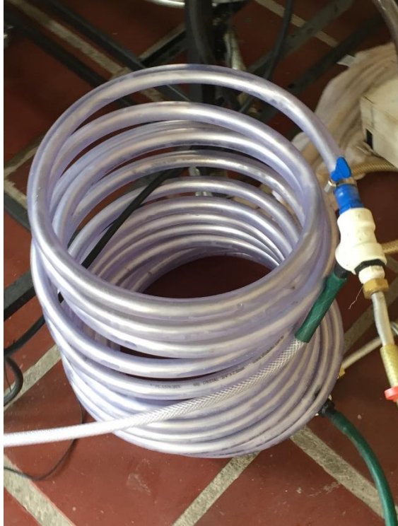
Figura 49. Chiller de contra fluxo.
