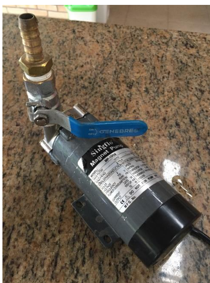
Figura 50. Bomba magnética MP 15R
