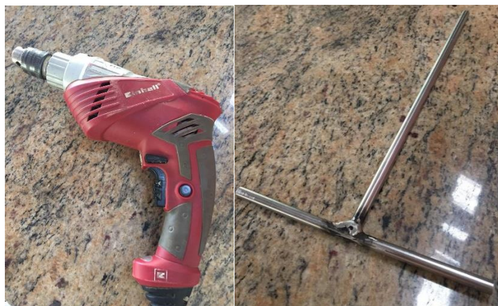
Figura 56. Furadeira Einhell RT-ID 65 e Pá de whirlpool em inox
