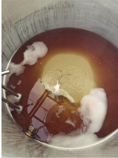
Figura 68. Trub obtido com whirlpool com furadeira
