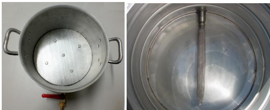
Figura 11. Sistema de filtração via fundo falso (esquerda) e bazooka (direita).
