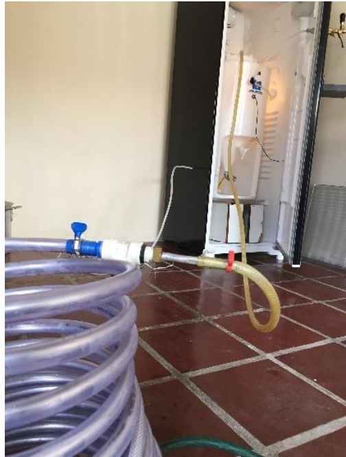
Figura 69. Arranjo do “pré-chiller” e trasfega para o fermentador
