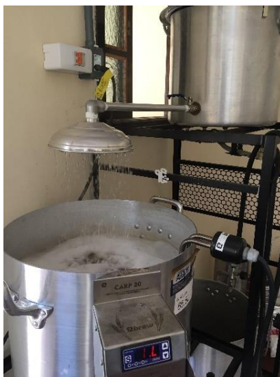
Figura 65. Lavagem dos grãos utilizando o método fly sparge
